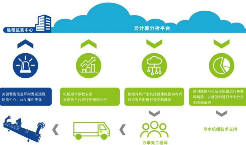
图八：基于云平台的远程智联冷水机组工作原理
